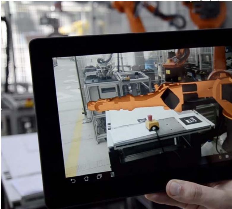
Abbildung 5: System zur intuitiven Roboterprogrammierung mit Unterstützung durch Augmented Reality (siehe Fußnote 4).
