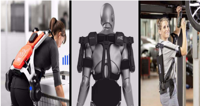
Abbildung 14: Aufbau und Anwendung soft-robotischer Orthese zur Kraftunterstützung des Erkers in der Montage.
